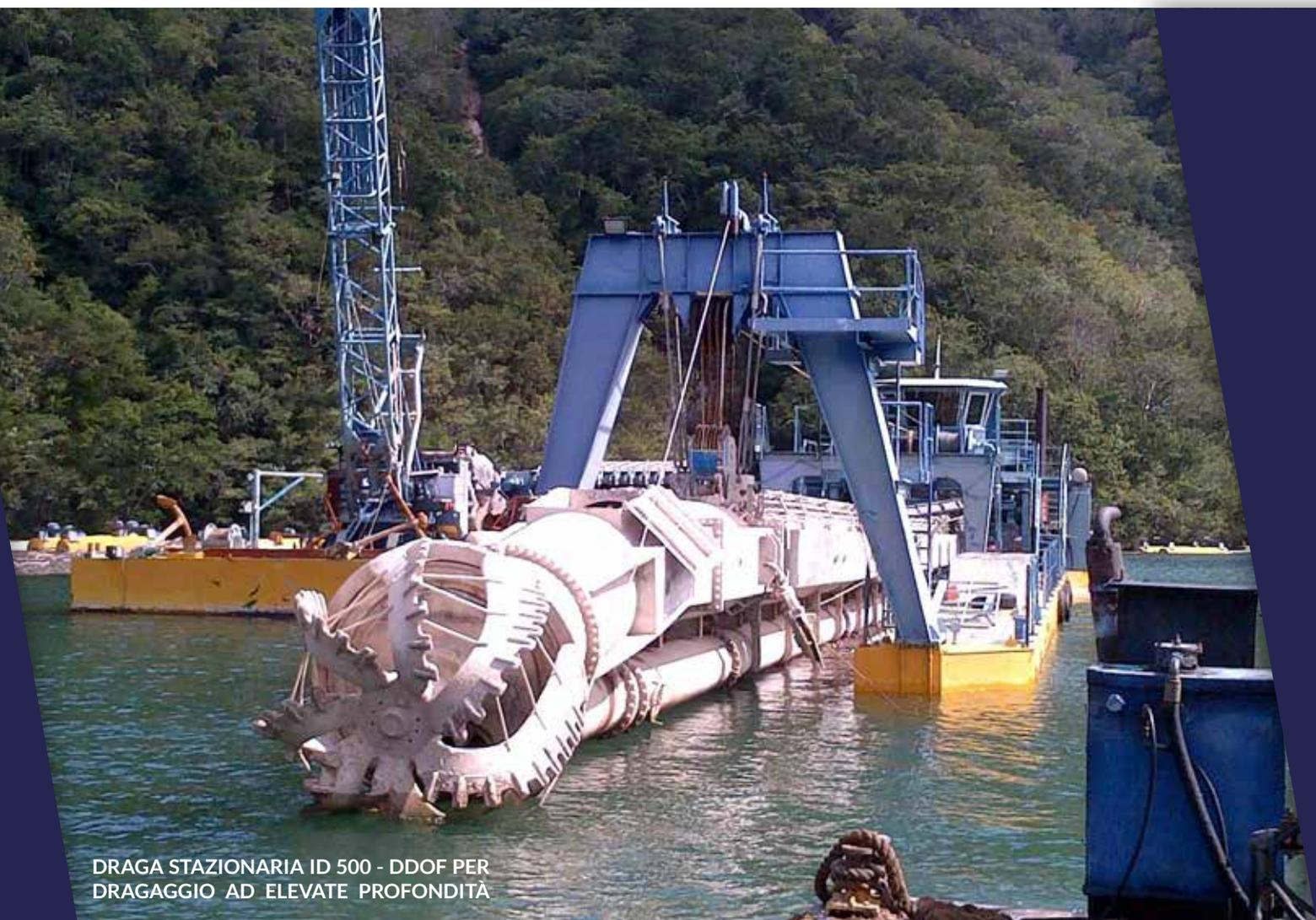
DRAGA STAZIONARIA ID 500 - DDOF PER DRAGAGGIO AD ELEVATE PROFONDITÀ
