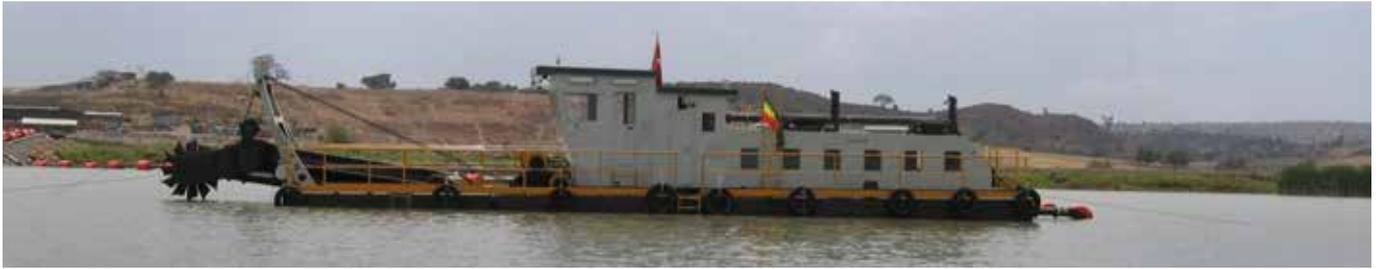
La draga a pompa con disgregatore a tazze non solo è il più economico e il più produttivo sistema di dragaggio esistente, ma anche il più ecologico: la produzione costante, il basso consumo di potenza e le maggiori concentrazioni di solido trasportato con conseguente riduzione della quantità di acqua necessaria per il refluito del materiale, unitamente all'utilizzo di oli completamente biodegradabili, fanno tendere allo zero l'impatto ambientale della draga.
